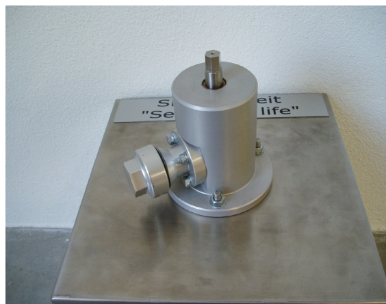
Dispositivo de recuperación montado sobre la superficie – listo para taladrar
